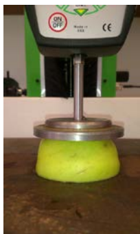
Obrázok 1. Priečne zaťaženie hemisféry jablka Kompresia medzi dvoma paralelnými platňami
