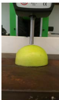
Obrázok 2. Priečne zaťaženie hemisféry jablka Kompresia po použití valcového indentera priemeru 8 mm s plochým koncom
