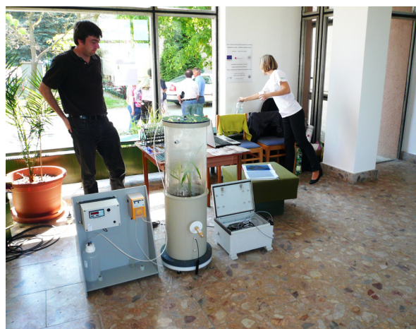
Obrázok: Laboratórny lyzimeter slúži na štúdium procesov v pôde v laboratórnych podmienkach a je obdobou lyzimetrov, ktoré sa nachádzajú v reálnom prostredí na štúdium vzťahov pôda-rastlina.
