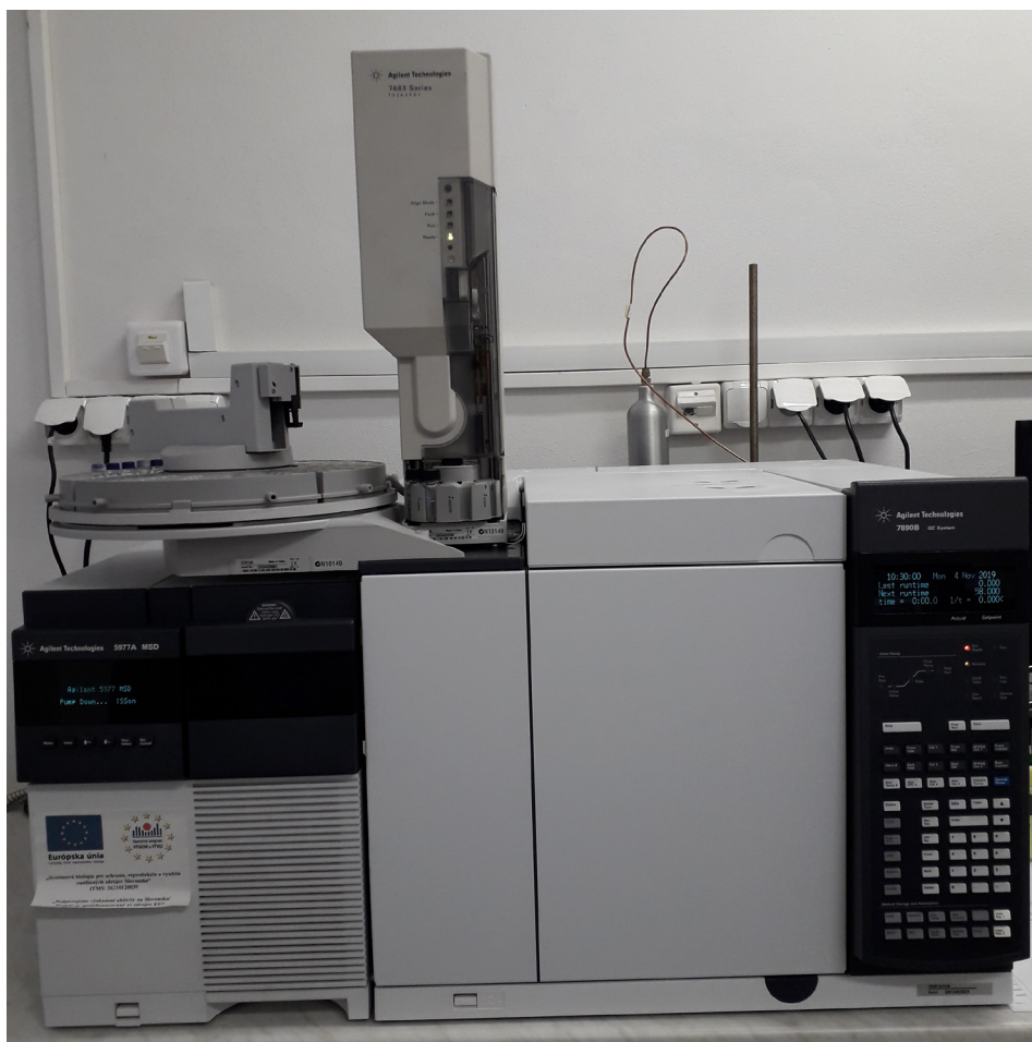
Chromatografický prístroj Agilent Technologies 7890B GC System v spojení s hmotnostným spektrometrom Agilent Technologies 5977A MSD je vhodným nástrojom na stanovenie profilu mastných kyselín vo vzorke rastlinného oleja. Foto: M. Havrentová
