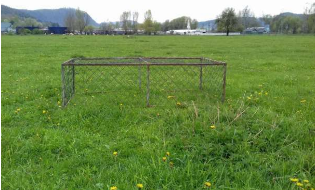
Obrázok 3 Kovová klietka na zisťovanie množstva produkcie fytomasy
